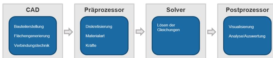
Abbildung 2.1: Pipeline des Simulationsprozesses im CAE-Bereich
